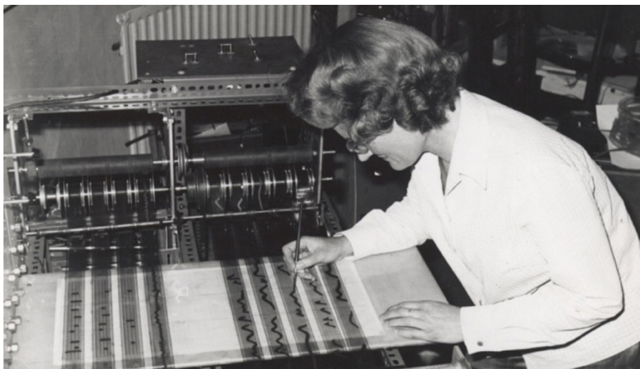
Figura 2: Foto promocional de Oram, c. 1966. Aquí está trabajando en la sección de control de volumen analógico. A la izquierda de las pistas de la película, están las tres pistas de control de tono digital y luego la pista de vibrato, notaciones gráficas . DaphneOram. https://www.daphneoram.org/oramicsmachine/
