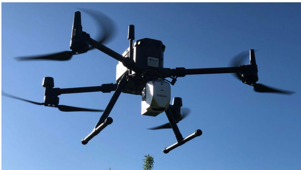
**Figura 2.** UAV DJI Matrice 300 RTK + CHC AA450
