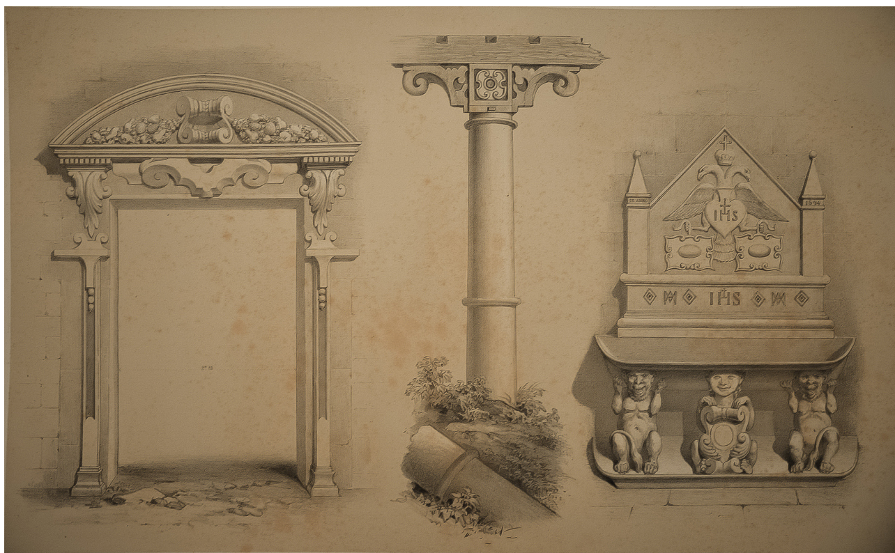
Fig.1. F. Sorrieu. Dibujo del natural de Alfred Demersay. Les Missions du Paraguay. Détails d'architecture. Porte latérale (côte Est) de l'église de San-Borja. Colonne en bois de la Galerie (Est) de l'église de San-Borja. Fontaine dans le Collège de San-Lorenzo [1846]. Litografía. 41 x 25.5 cm. 1860. British Library, 1854.d.1. Londres.
