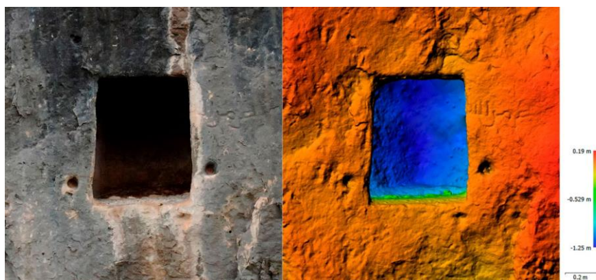
Figura 4. Ortofotografía y Modelo Digital de Elevaciones (DEM) 7 con sombreado y rampa de colores (E.R.T. – Panograma Labs)
