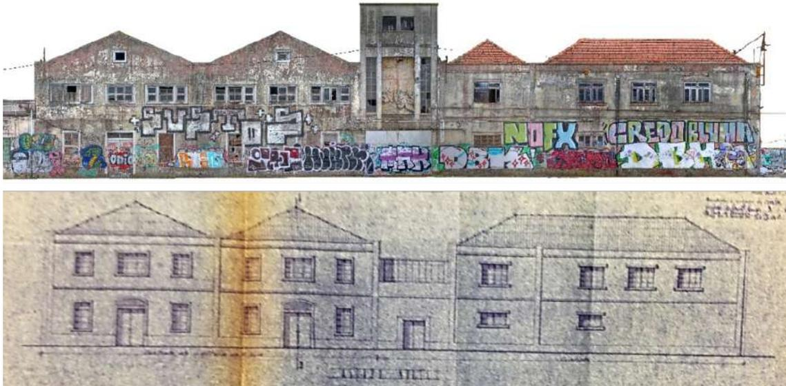
Ilustración 1. El edificio de COPENAVE en 2018 (levantamiento fotogramétrico de García Fernández) y extracto del proyecto de reforma del solar de 1958 (Centro de Documentação e Informação da APL - Administração do Porto de Lisboa, SA) donde puede apreciarse parte de las alteraciones del edificio para adaptarlo a los nuevos requisitos de la cadena de producción. Con permiso para su publicación en erph.
