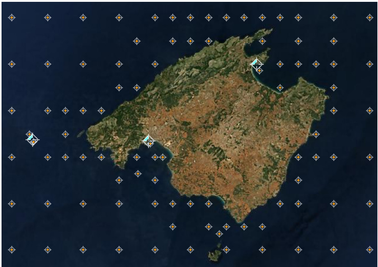
Figura 4. Distribución espacial en Mallorca de los dos mareógrafos terrestres de Palma y Alcúdia (red REDMAR), la boya de aguas profundas de Dragonera (red REDEXT) y los puntos de datos simulados de la red SIMAR.
