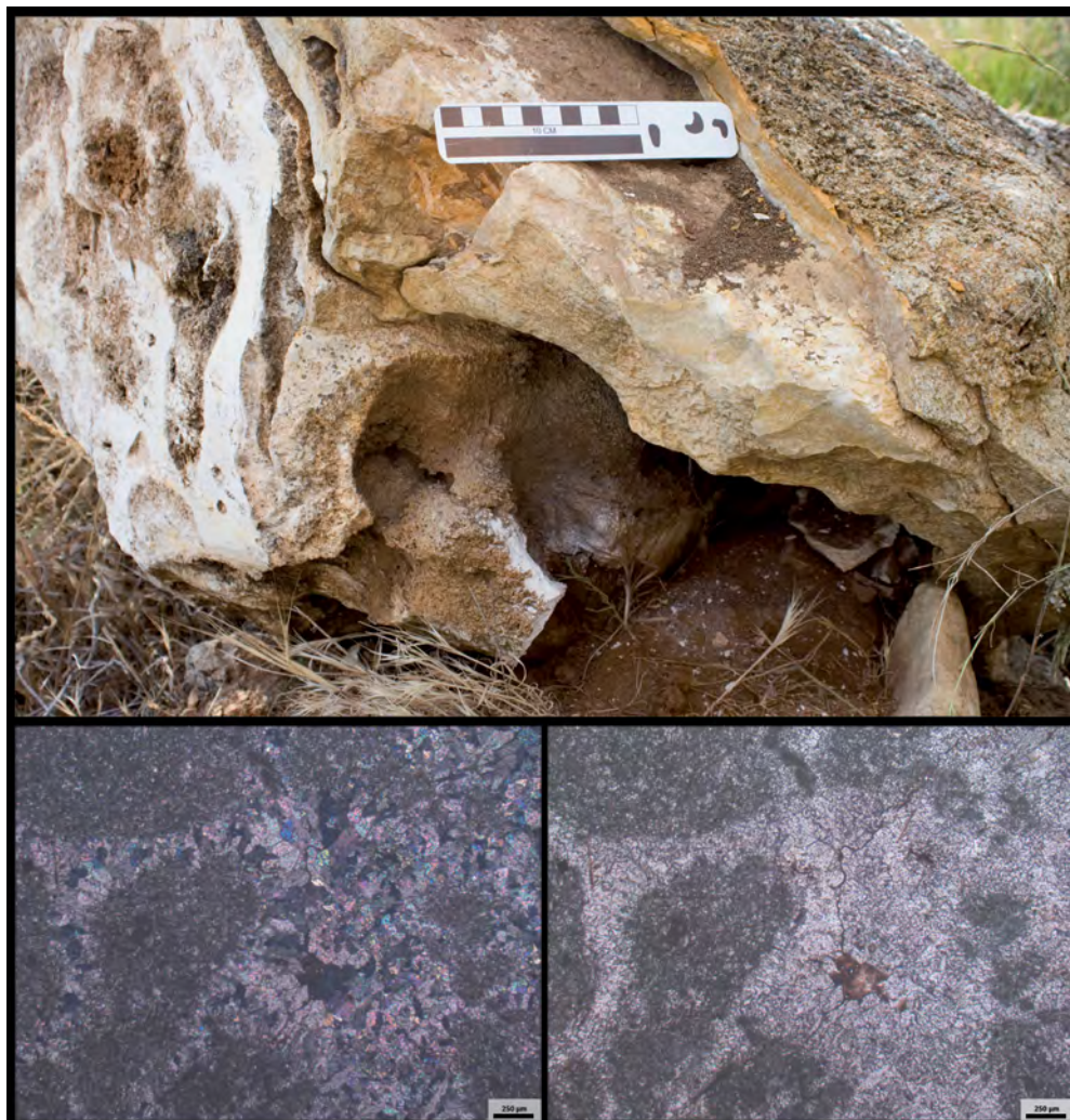
Lám. VIII.—Sílex con resto de caliza encajante del sílex de Juarros. Foto de lámina delgada con luz polarizada y no polarizada, donde se observa la textura micro-esparítica, con recrecimientos esparíticos y oxidaciones intersticiales (fotos petrográficas ©M. Soto).
