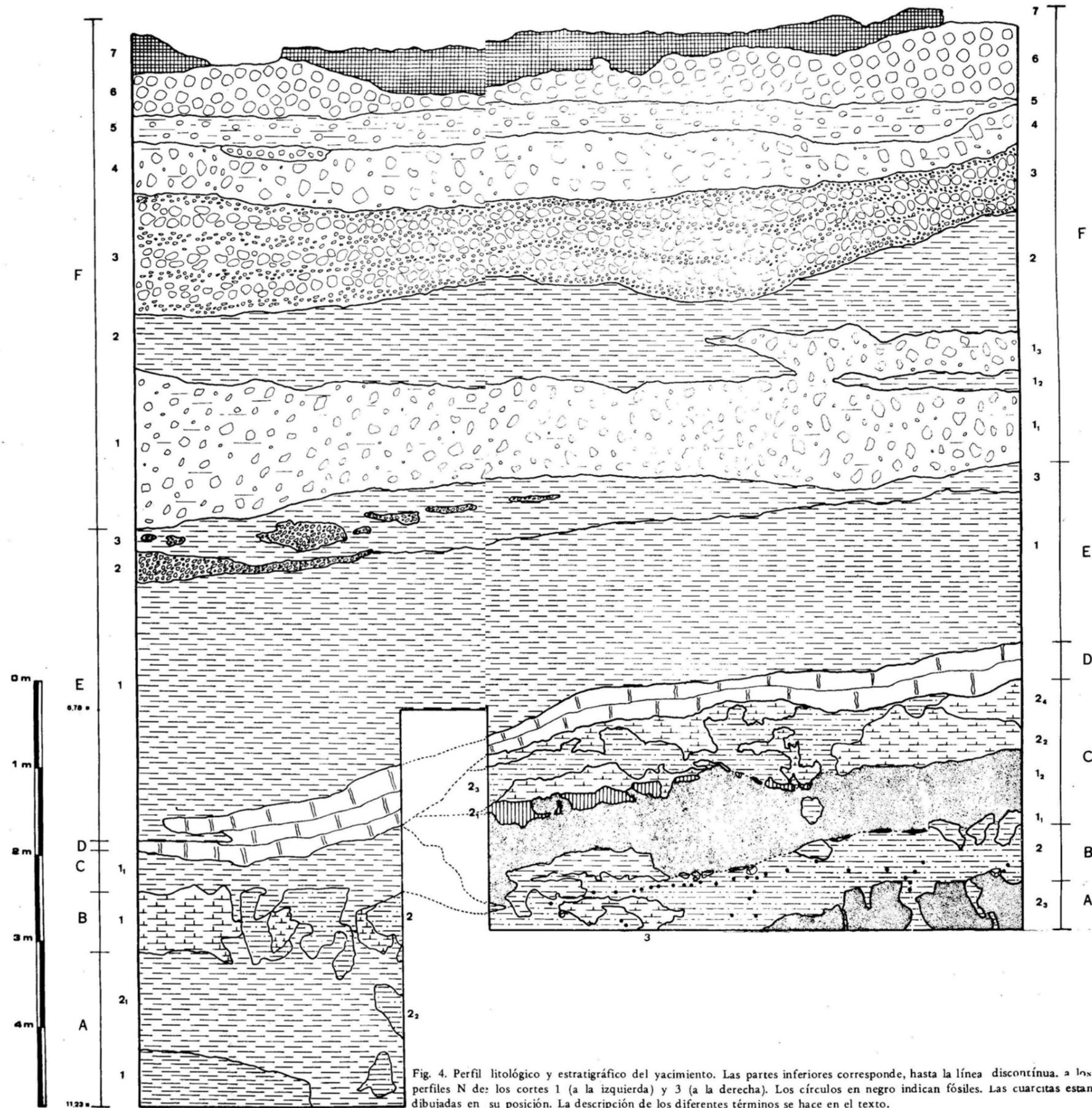
Fig. 4. Perfil litológico y estratigráfico del yacimiento. Las partes inferiores corresponde, hasta la línea discontinua, a los perfiles N de: los cortes 1 (a la izquierda) y 3 (a la derecha). Los círculos en negro indican fósiles. Las cuarcitas están dibujadas en su posición. La descripción de los diferentes términos se hace en el texto.
