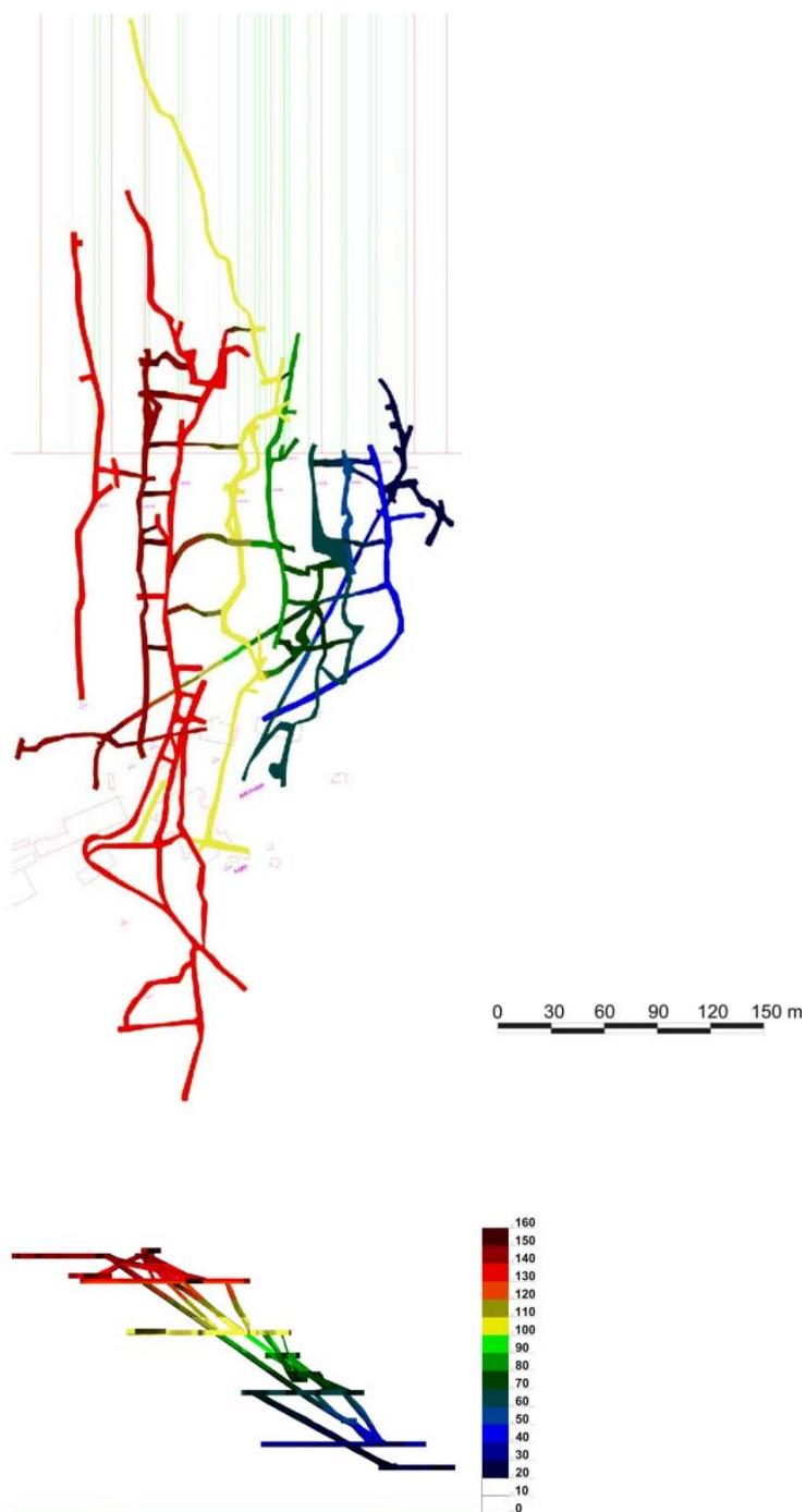
Fig. 6.—La mina de Arditurri 20 en planta y sección. Los colores indican los niveles topográficos de menor a mayor profundidad; por debajo de la cota 160 m toda la mina está inundada, manteniéndose en seco el resto de los trabajos gracias al funcionamiento del acueducto romano.
