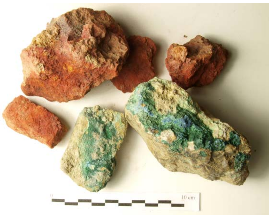
Lám. III.—Óxidos de hierro y carbonatos de cobre de Sa Mitja Lluna.
