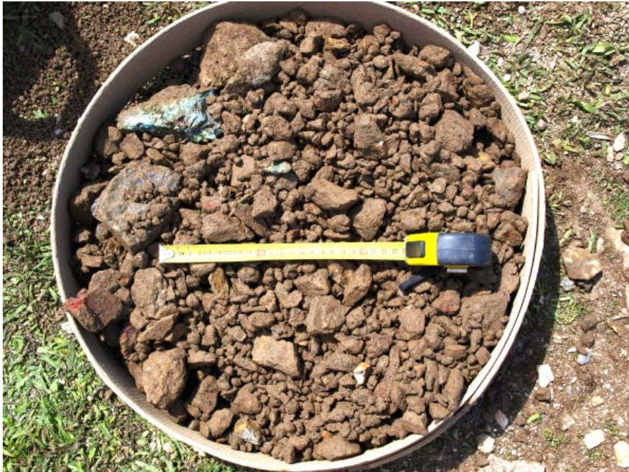
Lám. II.—Roca fragmentada con mineralizaciones de cobre y de hierro.
