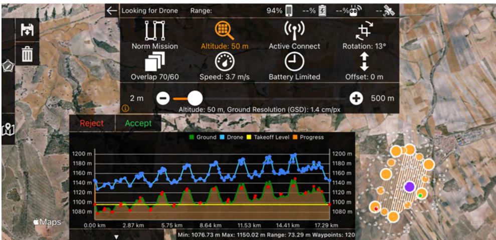
Fig. 3.—Parámetros utilizados para la realización del vuelo UAV con perfil del desplazamiento vertical de acuerdo a la topografía del terreno.
