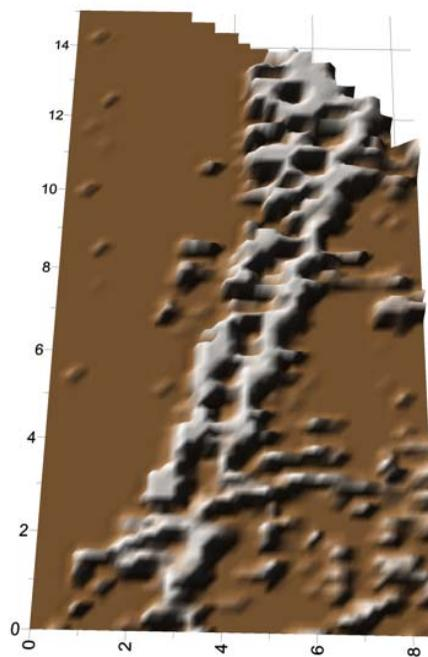
Fig. 7.—Superficie alabeada, entre 30 y 155 cm de profundidad. Esta imagen está construida en base a las rebanadas georrádar y en ella se observa con más nitidez, fundamentalmente en la parte central y sur, los rectángulos vacíos adosados al muro.
