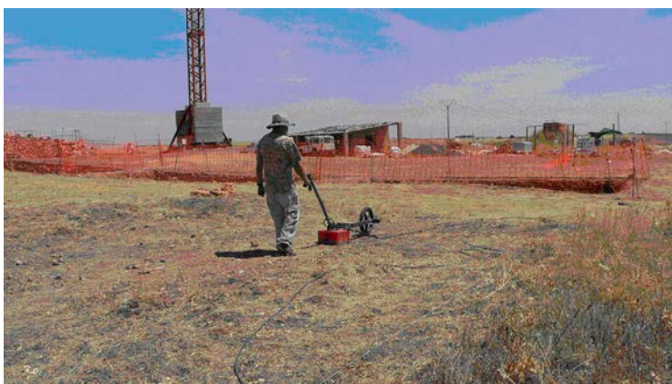
Lám. III.—Adquisición de un perfil georrádar; la antena de 400 MHz se desliza a lo largo de un cordel guía y el odómetro (rueda marcadora) va marcando la distancia horizontal.
