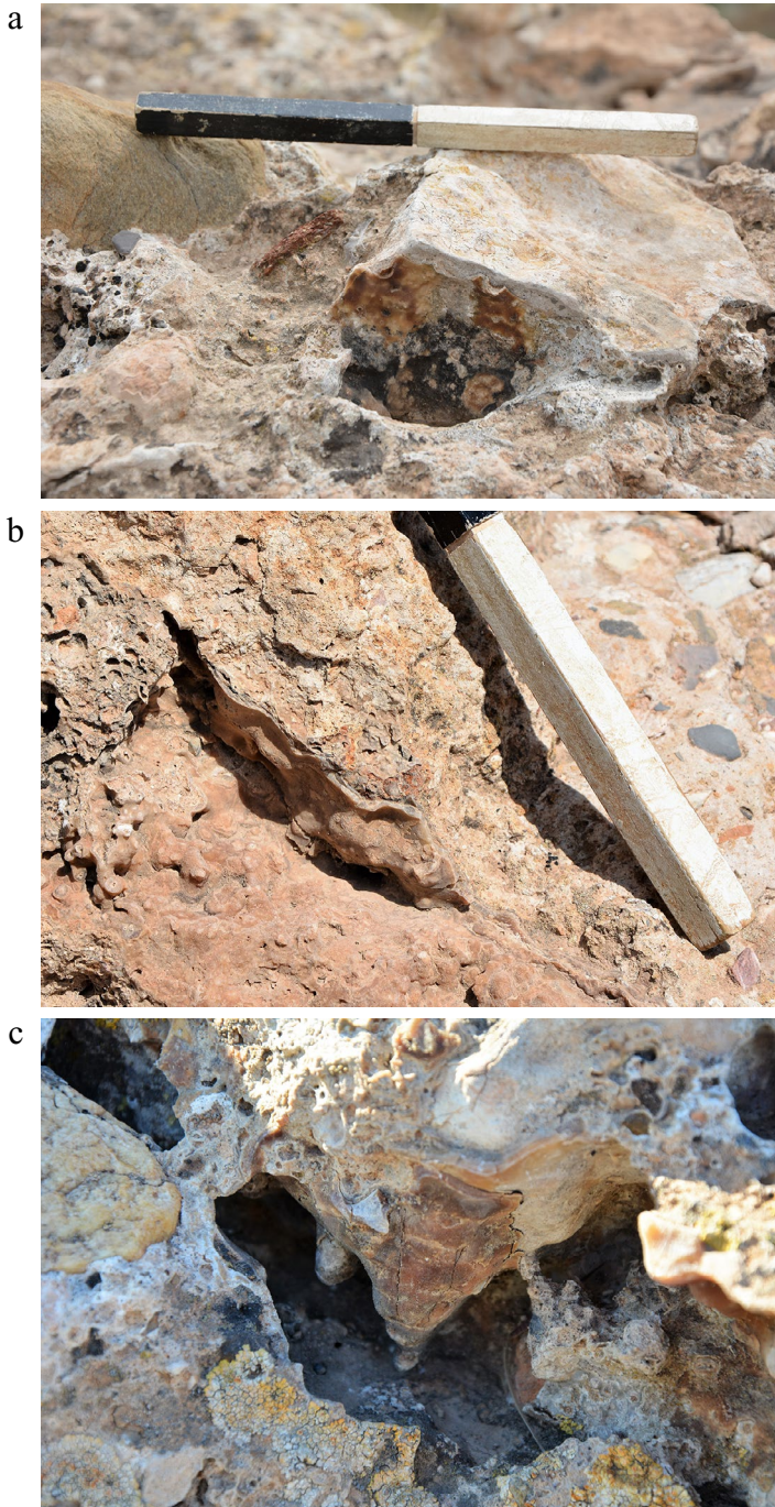
Fig. 4.—Capas estalagmíticas en los cimientos del acueducto de Los Millares, tramo 2: a) fragmento de cerámica calcolítico, de datación imprecisa, junto a una acumulación de carbonato cálcico plana vertical de color negro parduzco (muestra LM9); b) acumulación de carbonato cálcico horizontal y vertical; c) pequeña estalactita (muestra LM8).
