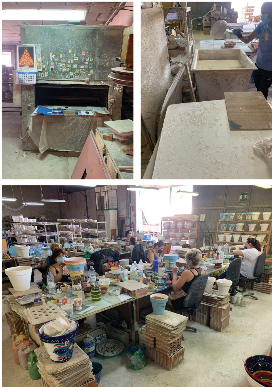
Fig. 13.—Arriba izquierda) Secadora industrial documentada en la fábrica de cerámica artística Padilla Padilla. Arriba derecha) Bañado con esmalte industrial realizado en la fábrica de cerámica artística Padilla Padilla. Abajo) Labores de pintado llevadas a cabo en la fábrica de cerámica artística Padilla Padilla.
