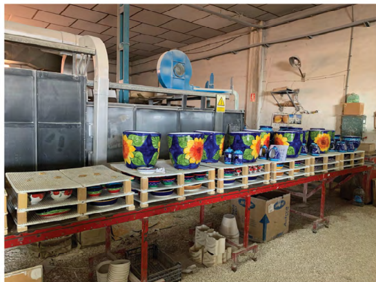
Fig. 14.—Proceso de cocción mediante horno túnel de gas documentado en la fábrica de cerámica artística Padilla Padilla.
