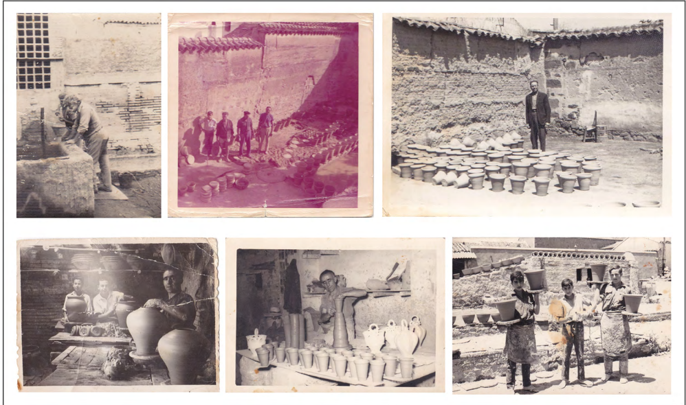
Fig. 3.—Arriba) Labores de decantación, pisado y secado en la alfar tradicional de “los Rosarios” a finales de los años 50. Abajo) Labores de modelado y secado en el alfar tradicional de “Santa Inés” a finales de los años 50 y principios de los años 60. (Fotografías cedidas por Juan Pedro Lendínez Padilla).
