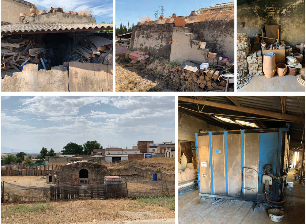
Fig. 9.—Arriba) Horno de tradición islámica abandonado y clausurado que se conserva en el taller alfarero de Antonio Padilla Herrera y Hno. Abajo izquierda) Amortización como corral de otro horno de tradición islámica, perteneciente a una antigua alfarería tradicional ubicada en el camino que conecta Bailén con la localidad vecina de Baños de la Encina. Abajo derecha) Actual horno industrial de gasoil utilizado para llevar a cabo la fase de cocción en el taller alfarero de Antonio Padilla Herrera y Hno.
