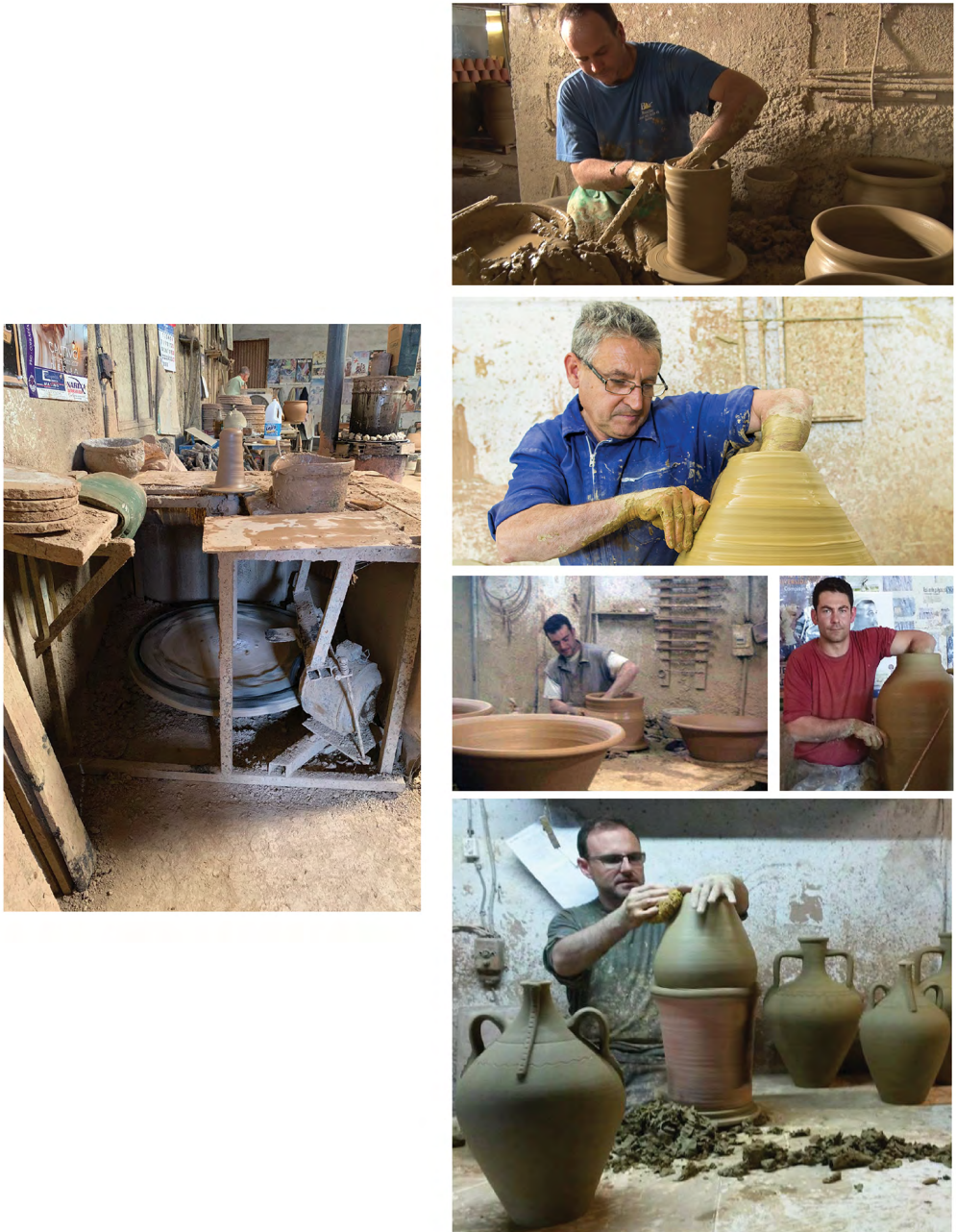
Fig. 7.—Izquierda) Torno de rueda tradicional con motor eléctrico incorporado. Derecha) Maestros alfareros bailenenses modelando con gestos técnicos tradicionales piezas cerámicas en el torno de rueda eléctrico.
