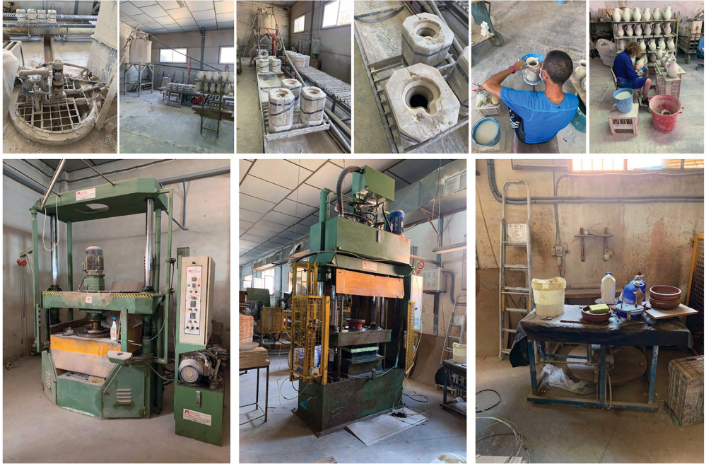
Fig. 12.—Arriba) Maquinaria y proceso de elaboración relacionados con la aplicación de la técnica del colaje de barbotina documentados en la fábrica de cerámica artística Padilla Padilla. Abajo) Máquinas rotativas con moldes abatibles que se disponen junto a un torno de rueda abandonado en la fábrica de cerámica artística Padilla Padilla.
