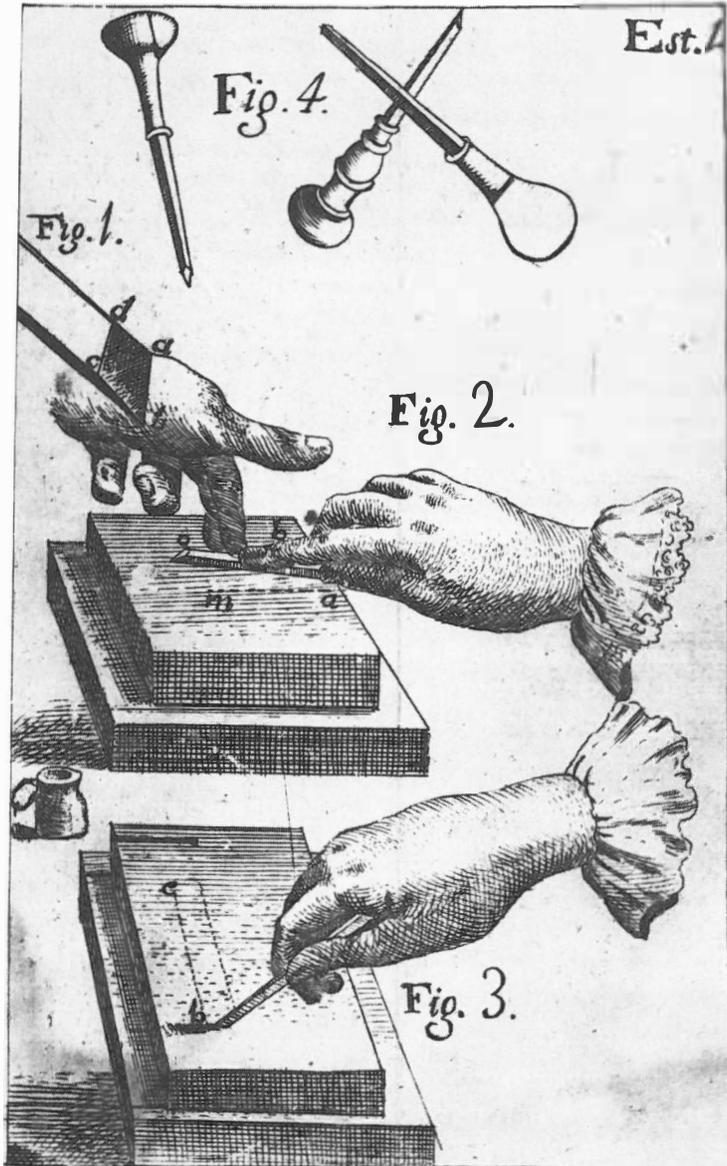
Ilustración del libro de D. Manuel de Rueda, sobre técnicas del grabado calcográfico: Fig. I: Sección de un buril. Figs. 2 y 3: Manera de afilar los buriles. Fig. 4: Buriles. (C. Particular).
