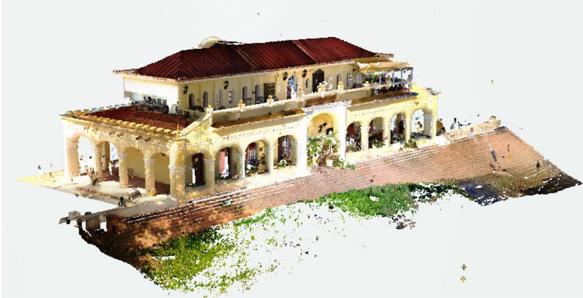
Fig. 8. Imagen creada en Scene 3D Point Cloud software a partir del levantamiento de escaneo 3D. Realizada por J. Negrete-Márquez; G. Rossi, M. Leserri. (2023).
