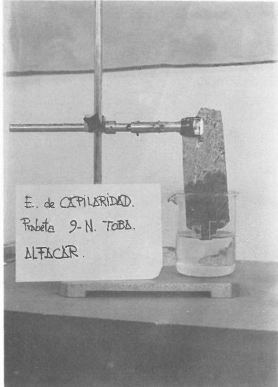
Ensayo de laboratorio, medición de la ascensión capilar por medio de los poros de la piedra interconectados
