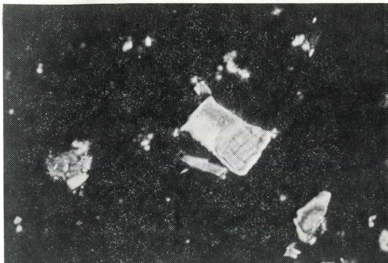
Fot. n.º 2.—Cristales de Whewellita con bandas intercaladas de colores verdes, azules, rojos, etc. En el centro se aprecia un cristal grande de Weddellita en proceso de transformación en Whewellita, Nic. Cruz. 160x.
