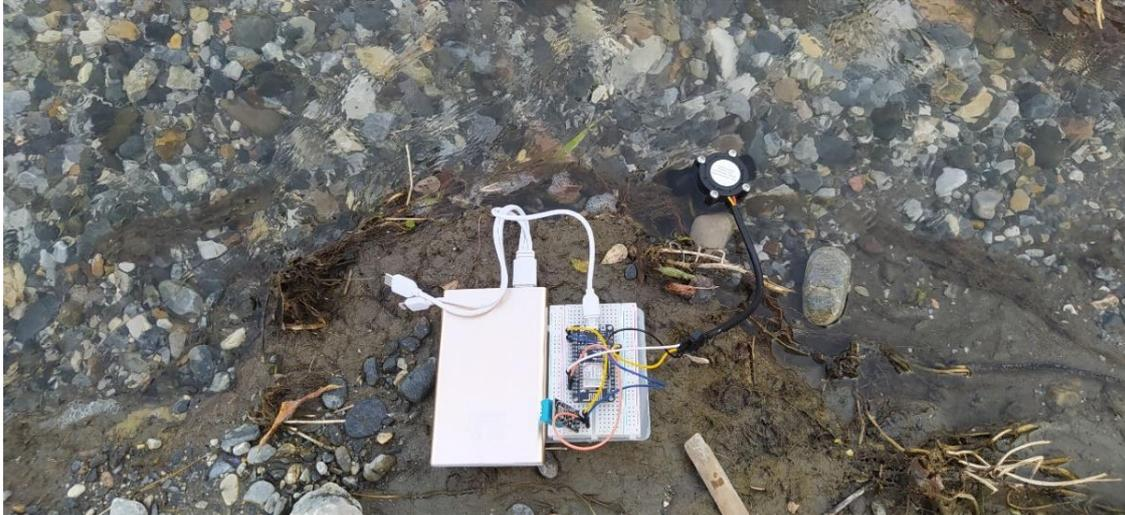
Fig. 10. Circuito de ESP32 con sensores de temperatura, presión y flujo de agua.
