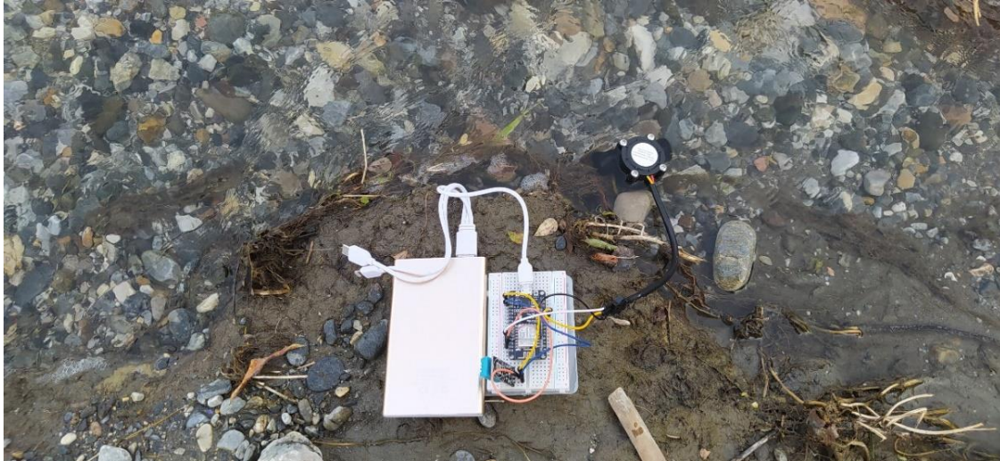
Fig. 10. Circuito de ESP32 con sensores de temperatura, presión y flujo de agua.
